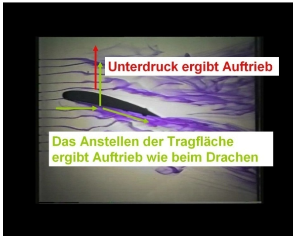
Bild 1.10: Über der Tragfläche entsteht ein Sog und unter der Tragfläche ein Überdruck
